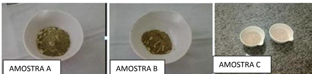
FIGURA 2 – Erva Mate :Amostra A - in Natura, Amostra B - dissecada, Amostra C - calcinada
